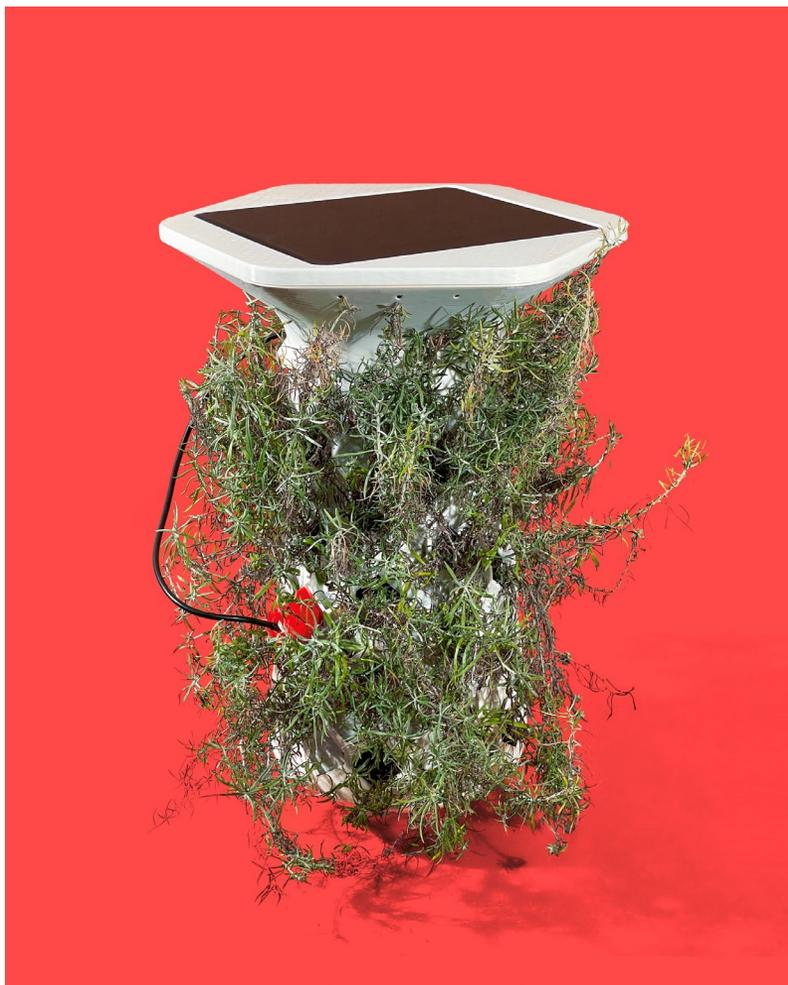
AURA SMART&AGRI è un kit didattico che permette a ragazzi, ragazze e insegnanti di partecipare ad un processo di apprendimento che inizia con la costruzione di un biofiltro vegetale e continua con il suo utilizzo, al fine di acquisire consapevolezza e conoscenza riguardo al ciclo di crescita delle piante edibili o aromatiche, alla qualità dell'aria e al processo naturale della sua purificazione dagli agenti inquinanti.
