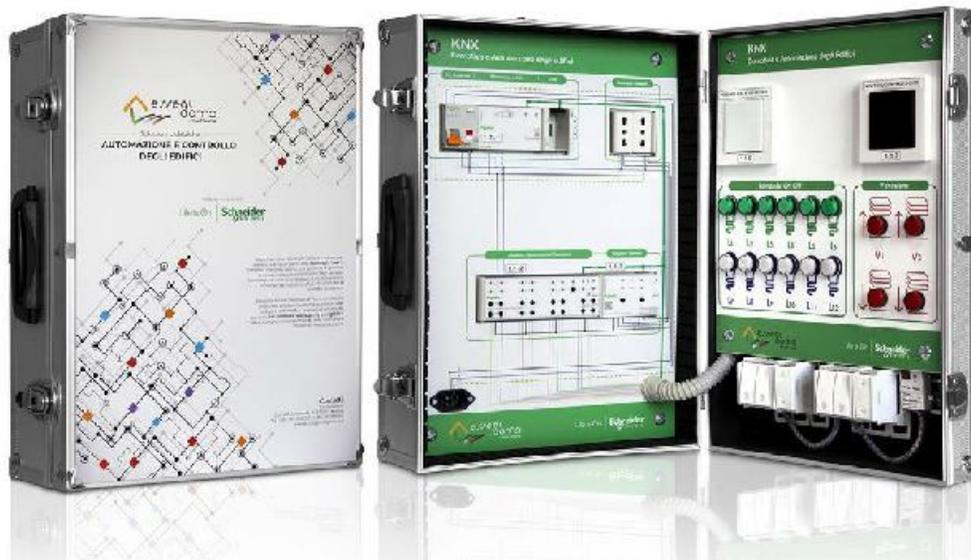
Il kit comprende l'insieme dei dispositivi domotici per la realizzazione di impianti per home automation con standard KNX. La soluzione permette agli allievi di comprendere e realizzare le principali funzioni per la gestione intelligente degli impianti elettrici per edifici residenziali e commerciali, nell'ottica dell'efficienza energetica, comfort e sicurezza.
